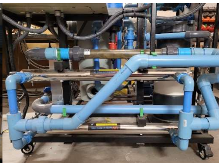
Planta aguas grises con AOP
