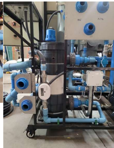
Planta aguas grises con AOP
