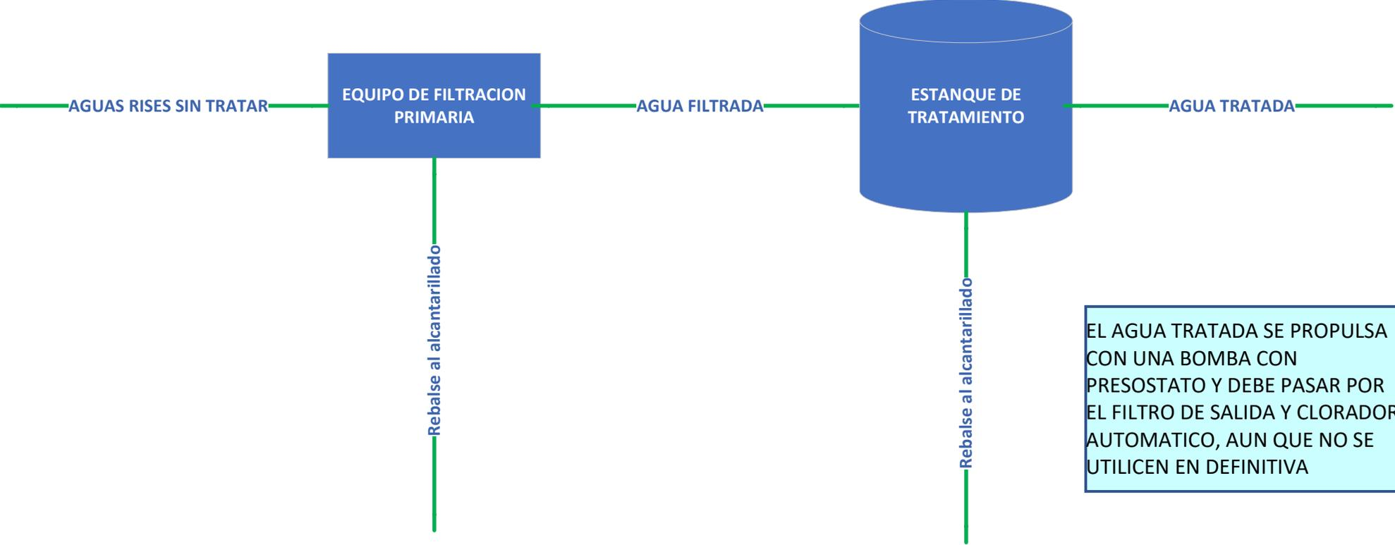
EL AGUA TRATADA SE PROPULSA CON UNA BOMBA CON PRESOSTATO Y DEBE PASAR POR EL FILTRO DE SALIDA Y CLORADOR AUTOMATICO, AUN QUE NO SE UTILICEN EN DEFINITIVA
